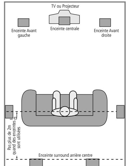
B) La distance entre les enceintes gauche et droite doit être égale à la distance entre votre position d'écoute et l'écran. Vous pouvez également faire un essai avec les enceintes placés légèrement en avant de l'enceinte centrale. Des enceintes arrières centre sont facultatives pour les configurations 5.1.
